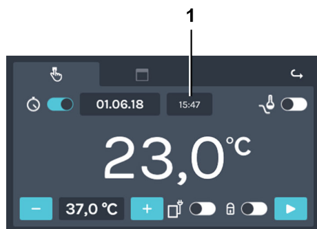
Рис. 70: «Ручной режим → Задержка запуска → Время запуска»
