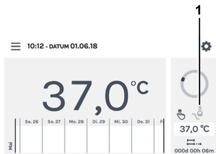
Рис. 64: Главный экран: профиль снижения температуры доступен, но неактивен
