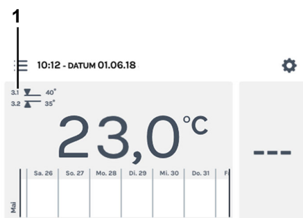
Рис. 59: Главный экран в режиме останова с активным термореле
