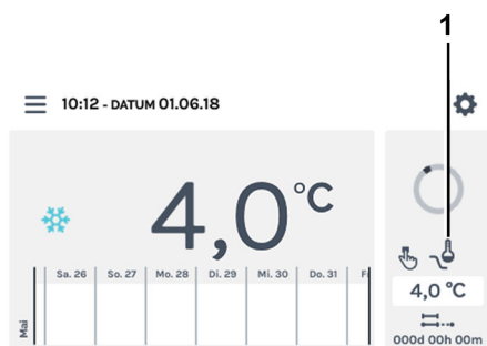
Рис. 65: Главный экран: профиль снижения температуры доступен и активен
